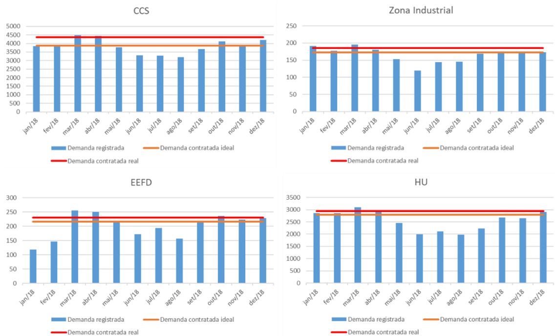
Figura 45: Análise de demanda contratada para as subestações: CCS, Zona Industrial, EEFD e HU.
